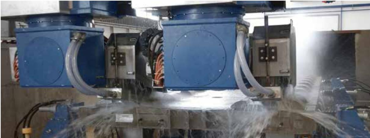
2 | Schleifmaschine schleift die produzierten Fahrbahn Elemente nach dem Aushärten in Form.
